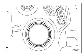
(d) Remove the gasket from the fuel tank.
